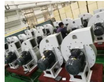
直驱发电机空冷风机
